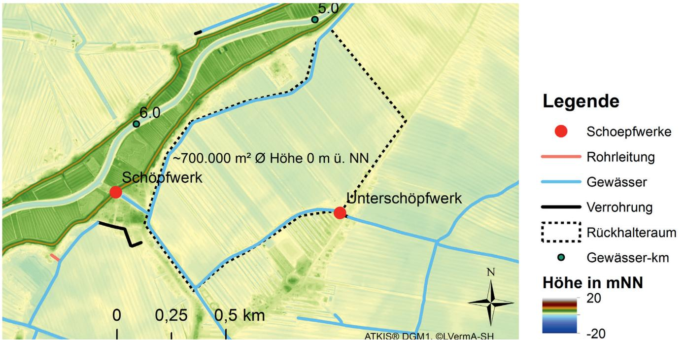
Abb. 47: Mögliche temporäre Staufläche im Rückstaubereich der Schöpfanlage Kurzenmoor (TUHH 2014)
