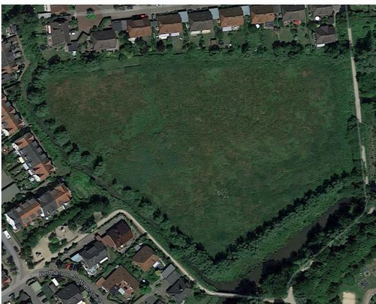
Abbildung 44 zeigt die sukzessive Flutung der Sportplätze bei ansteigendem Wasserstand. Es ist darauf geachtet worden, dass nicht beide Mulden gleichzeitig mit Wasser gefüllt werden, was bei erhöhtem Wasserstand zumindest die Nutzung einer Mulde erlaubt.
