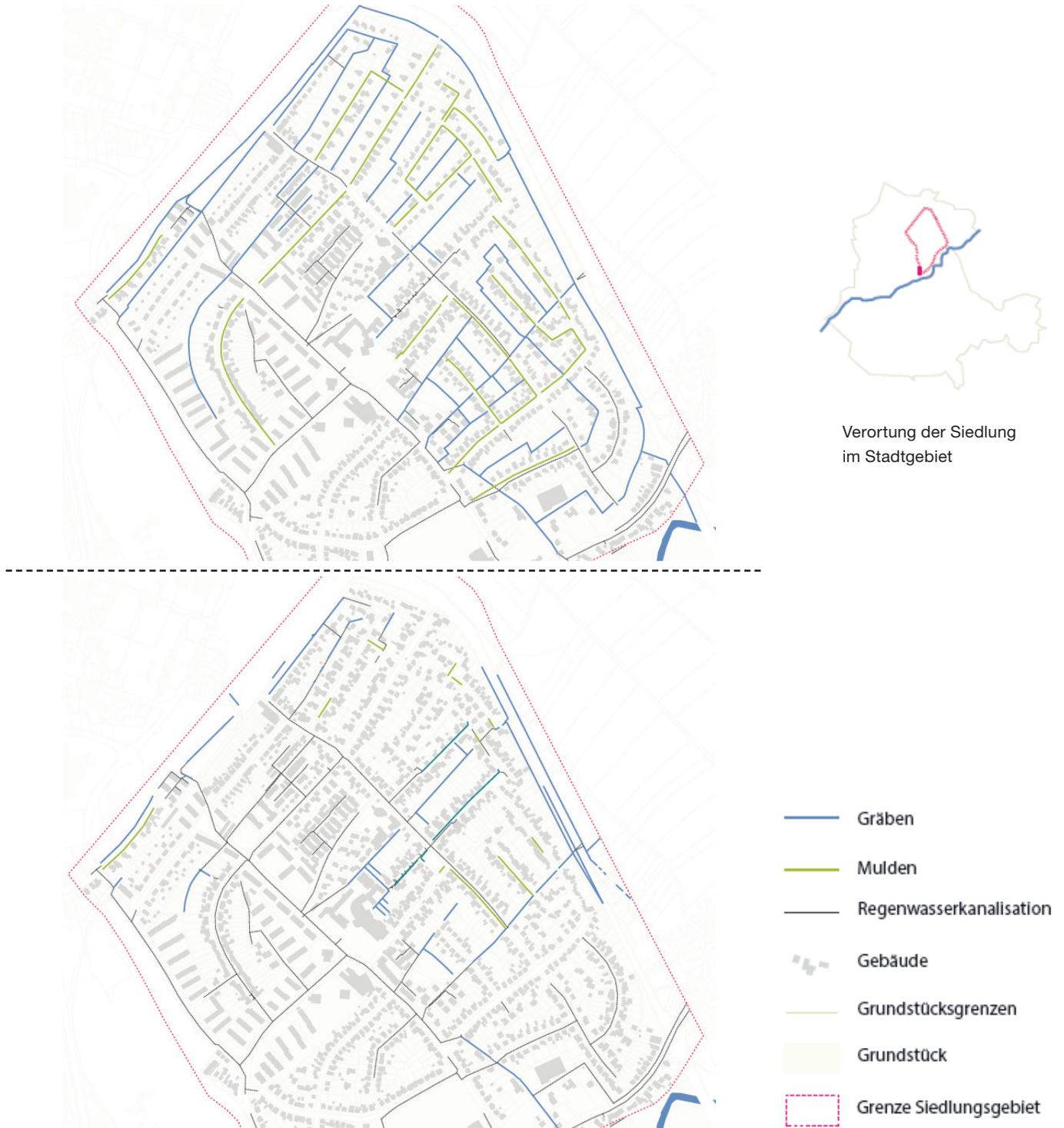
Abb. 15: Das ursprüngliche Entwässerungssystem der Siedlung aus den 1950er- / 1960er- Jahren (Abb. oben) im Vergleich zur aktuellen Situation (Abb. unten) (Römhild / Kruse 2012)
