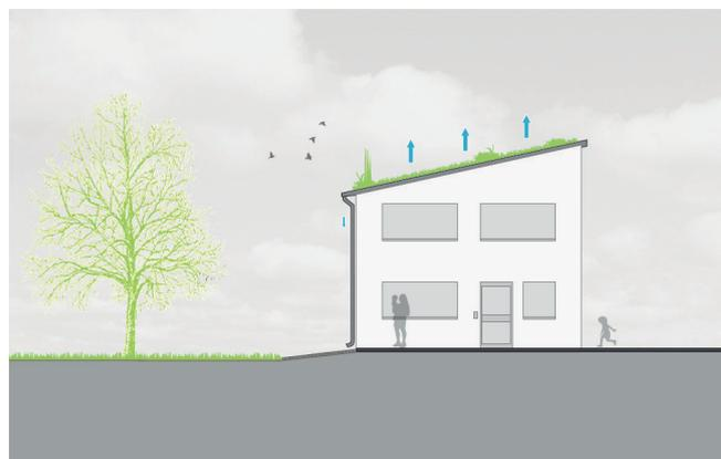
Abb. 36: Prinzipschnitt einer Dachbegrünung (HCU 2011)
